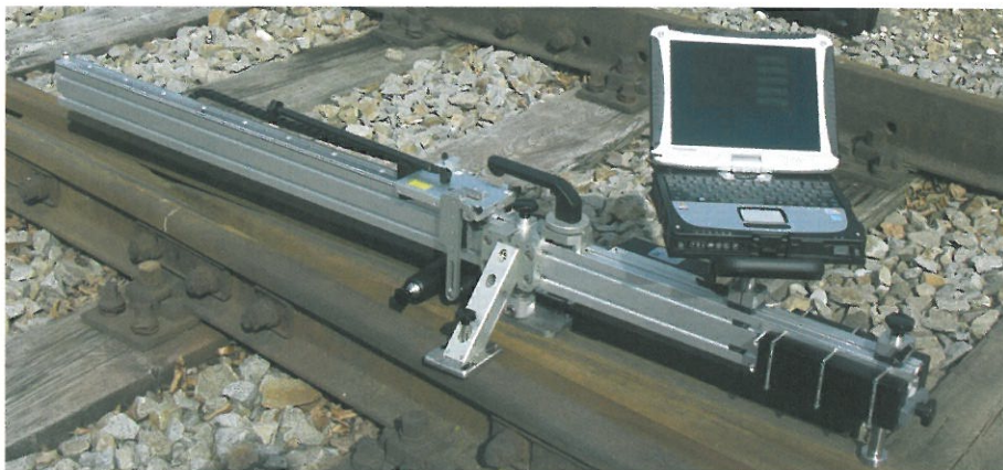
Abb. 7: Entwicklung Herzstückmessgerät – kurze Version
