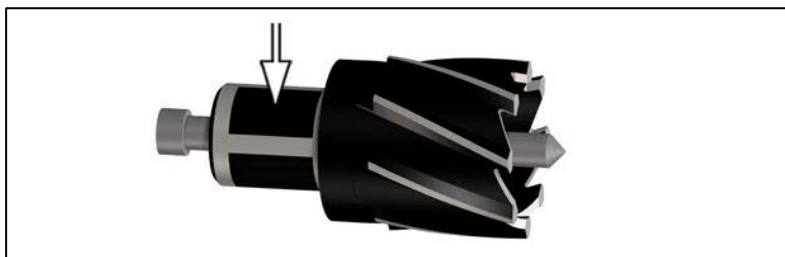
Afb. 20: Boor met boorschacht
