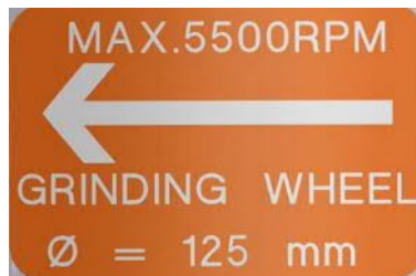
Afb. 31: Sticker "max. spiltorental, draairichting en grootte van het slijpmiddel" (voor machines met 125 mm slijpmiddel)
