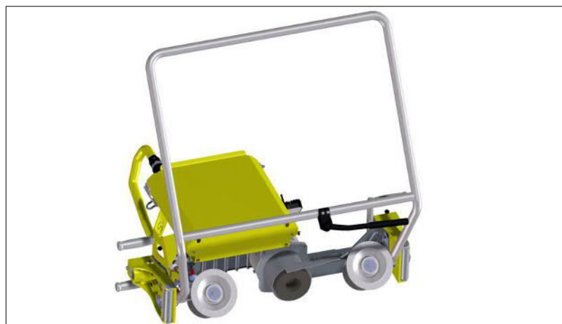
Afb. 43: Greep links in positie voor slijpen aan de zijkant
