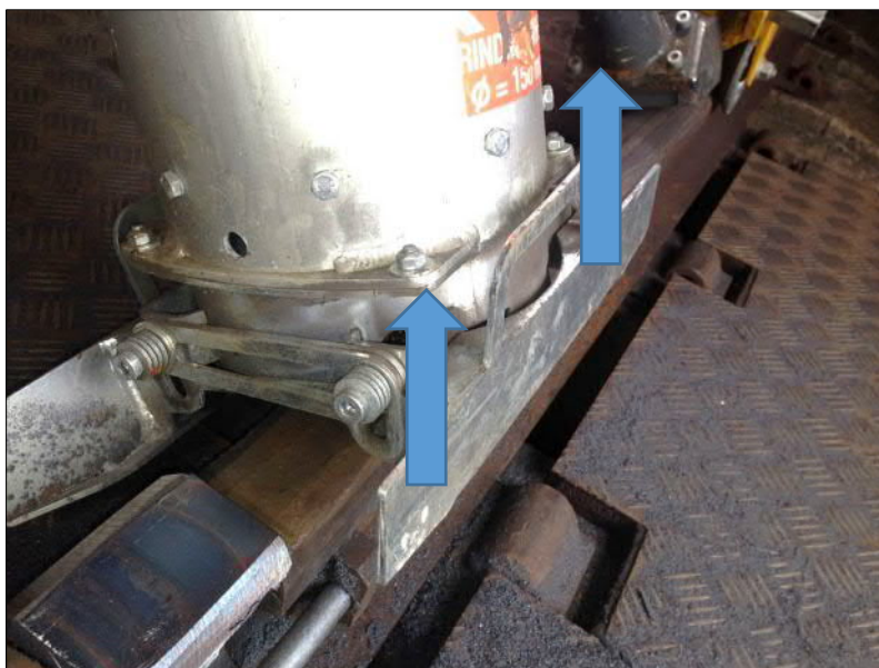
Afb. 87: Vouw de vonkenvanger omhoog (beide zijde)
