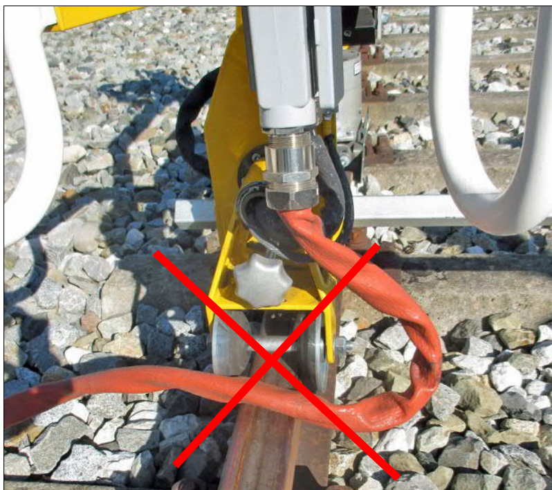
Afb. 49: Fout: kabel gevoelig voor beschadiging
