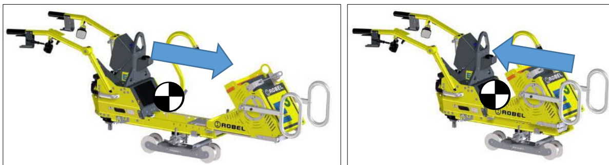
Afb. 51: Gewenste contactkracht instellen: linkerstand voor lage contactkracht, rechterstand voor hoge contactkracht
