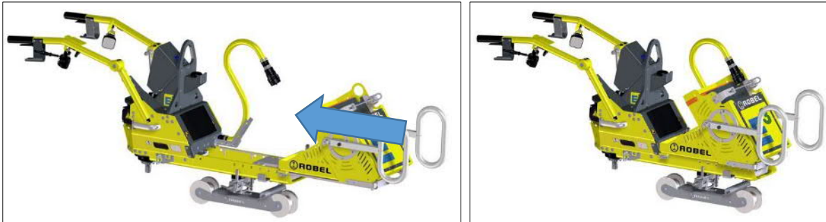
Afb. 116: Machine op kortste lengte brengen
