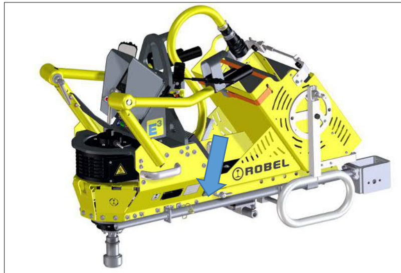
Afb. 121: Opbergen van de cantilever voor transport
