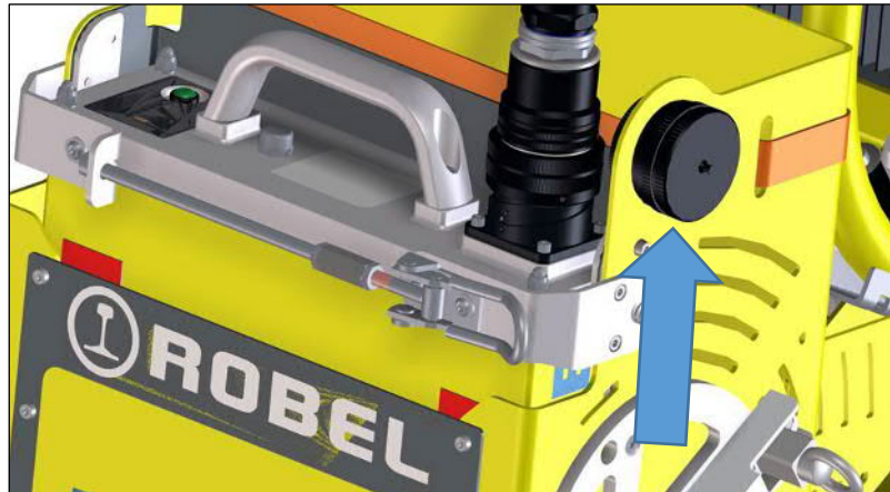
Afb. 53: Plaats de beschermkap in de beugel
