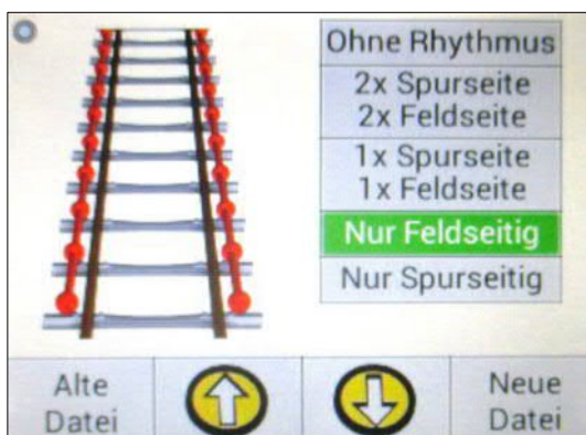
Afb. 75: Schroefpatroon „Alleen aan veldzijde“
