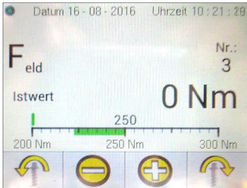
Afb. 85: Voorbeeld: koppel 250 Nm
