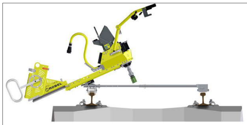
Afb. 64: De schroefspindel over de cantilever of het dwarsonderstel zwenken
