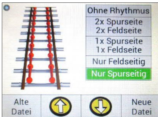
Afb. 76: Schroefpatroon „Alleen aan spoorzijde “
