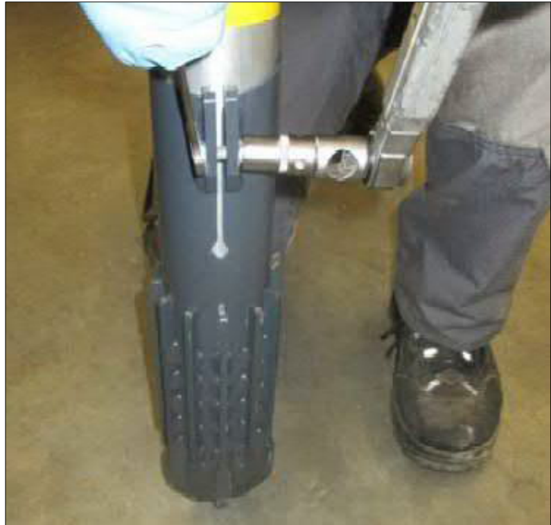
Afb. 41: De schroeven gelijkmatig met een draaimoment van 20 Nm vasttrekken
